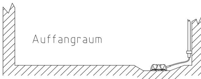
Die Leckagesonde wird direkt auf dem Boden von Wannen oder Räumen montiert. Die Sonde ist so am Boden der Wanne oder des Überwachungsraumes zu montieren, z.B. an der tiefsten Stelle, dass bei einer Leckage schon eine geringe Menge des auslaufenden Mediums die Fühlerelektroden sicher bedeckt und somit elektrisch-leitend verbindet.
